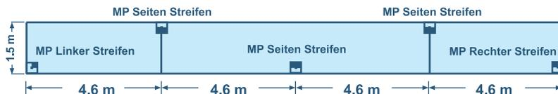
Ein weiteres Modell der MP Familie. Er bietet eine interessante Alternative zum beregnen streifenförmiger Flächen. Die 3 Modelle bieten eine verbesserte Gleichmäßigkeit und eine optimale Windresistenz.
